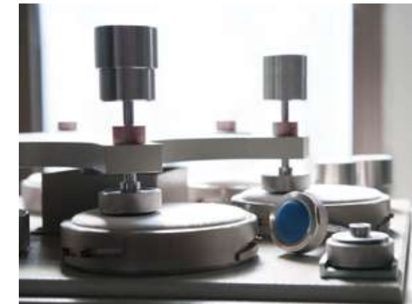
ABRASION TEST — Resistenza all'usura
