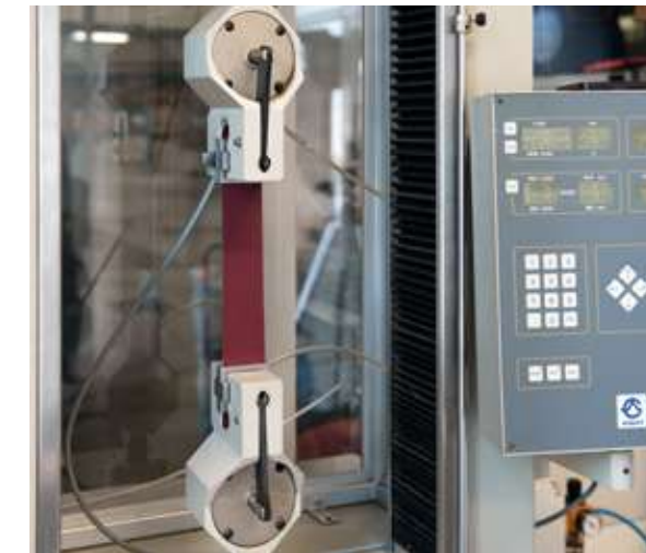
TENSILE TEST — Caratteristiche fisico-meccaniche
