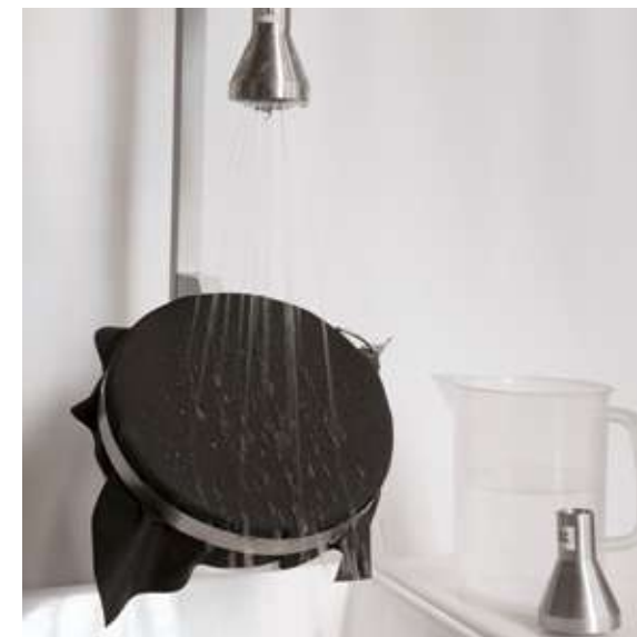
SPRAY TEST — Caratteristiche del finissaggio
