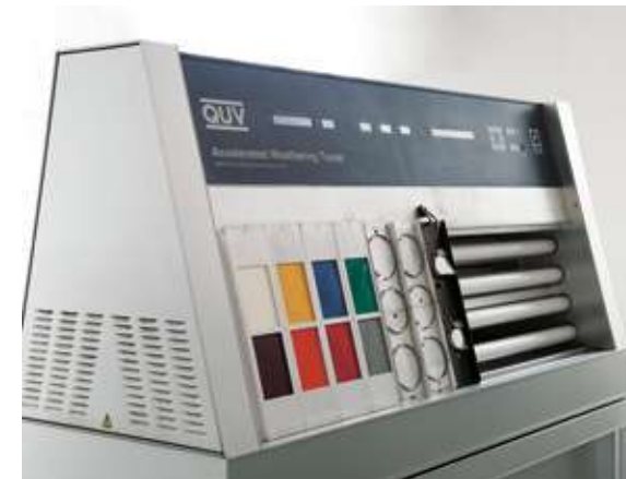
QUV TEST — Resistenza all'invecchiamento outdoor
