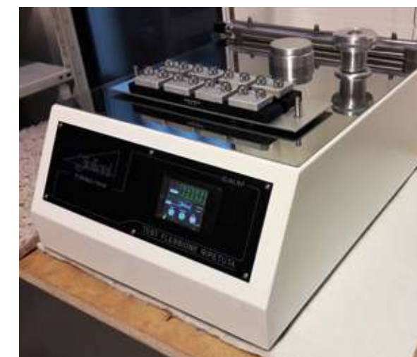
FLEX TEST — Resistenza alla piegatura
