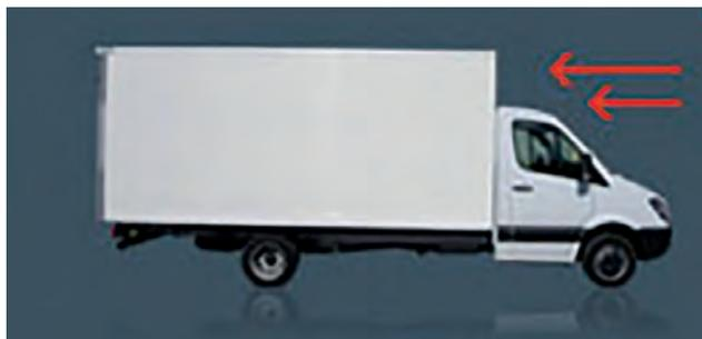
La potenza erogata dal motore per mantenere una velocità, deve bilanciare un numero di forze che tendono a frenare il veicolo.
