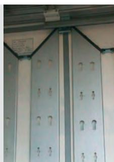
Per maggiore praticità, le carrucole superiori sono compatibili con i binari dei tetti VERSUS; mentre le carrucole inferiori corrono in un profilo ad omega in acciaio zincato che viene avvitato alla longherina del veicolo. OPEN BOX è inoltre caratterizzato da un particolare meccanismo di chiusura con chiave inserito in due montanti in acciaio della lar-
