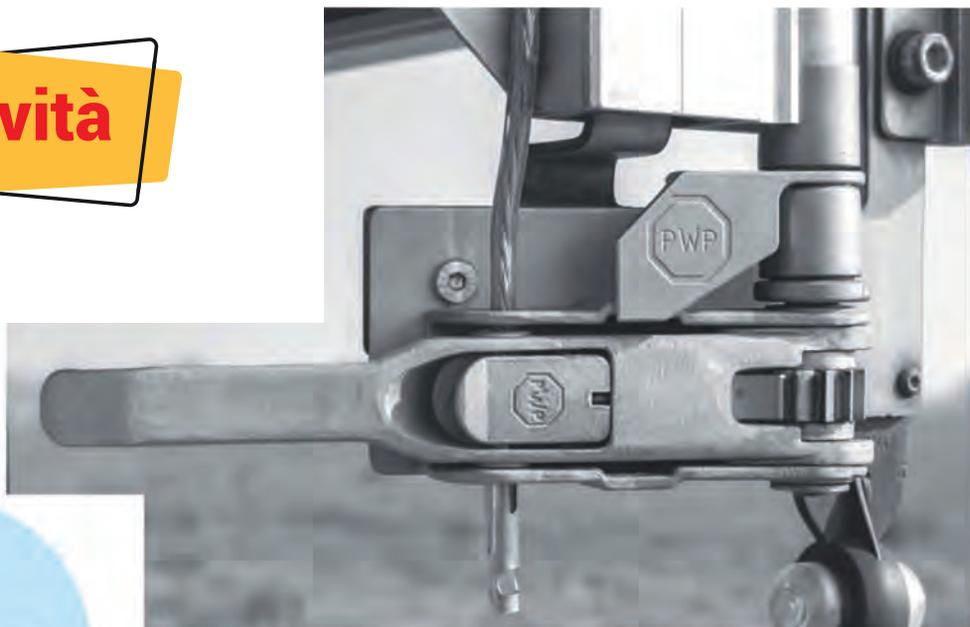
NUOVO PERNO DI SICUREZZA DA ADOTTARE SOLO CON TENDITORE PWP E CAVO TIR. IMPEDISCE DI SFILARE LA BARRA TENDITRICE GARANTENDO LA CHIUSURA DEL TELO LATERALE
