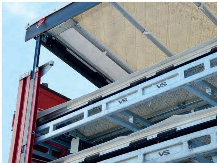
Questo tessuto, insieme al tetto Versus-Omega, è stato testato su un veicolo in una pista attrezzata per test estremi: test superato e risponde completamente alle norme severe EN12642XL.
