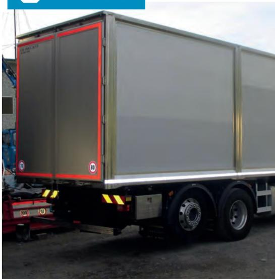
Esempio di una porta posteriore da 30 mm., montate su motrice e rimorchio
