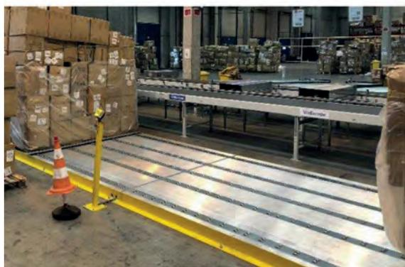
Modulo per movimentazione lineare dei pallet lungo tutto il magazzino
