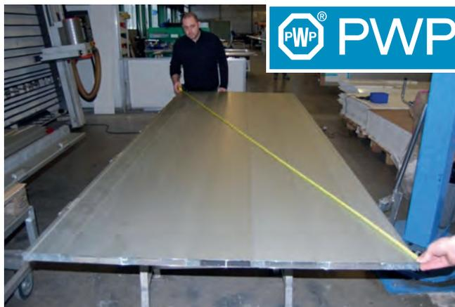
Fase di assemblaggio: terminato il bloccaggio delle doghe e dei profili verticali esterni, si verificano le diagonali
