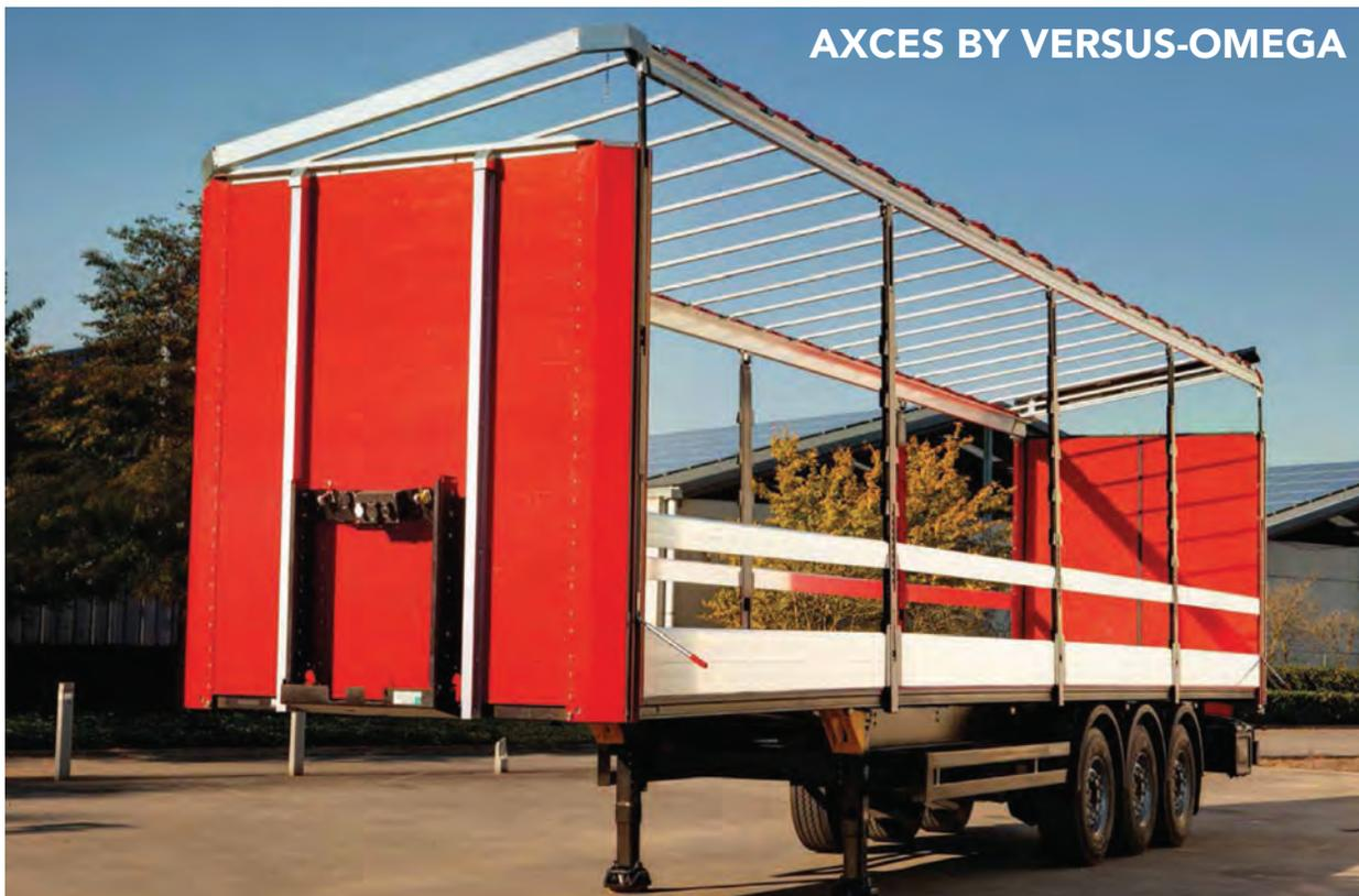
Axces è la linea di sollevamento dei tetti Versus-Omega che soddisfa tutte le esigenze degli autotrasportatori, consentendo di migliorare le operazioni di accesso al piano di carico in funzione dell'allestimento, riducendone complessivamente i tempi di carico-scarico del veicolo.
