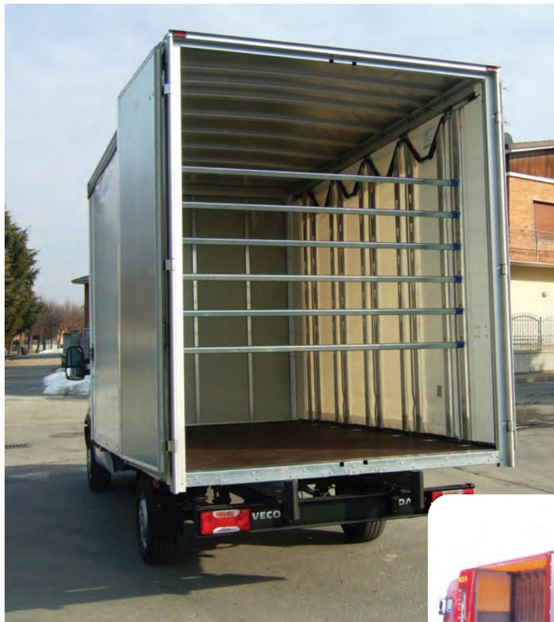
Il sistema a pannelli OPEN BOX si adatta perfettamente a veicoli di dimensioni e portate diverse. Per automezzi di portata fino da 3,5 tonnellate, OPEN BOX è composto da pannelli in alluminio della larghezza di 250 mm. L'altezza, infine, è variabile in funzione delle esigenze del cliente.
