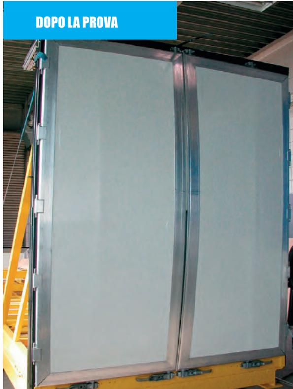
I test di resistenza effettuati sulle porte PWP "CLASSIC" nella versione 4 chiusure Boxer e pannelli sandwich, hanno dato ottimi risultati. La porta, dopo essere stata sottoposta a 3 differenti pressioni (60,80,120 mbar), ha brillantemente resistito alla sollecitazione, consentendo a fine prova l'apertura delle ante senza alcun problema.
